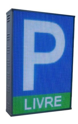
Fornecimento em 1 face ou 2 LED RGB 800mmx1120mm (área de visão) 600W (por face) Alto Brilho uso exterior Dimensões altura 1160mm largura 840 profundidade 190mm Caixa em alumínio com pintura de alta resistência
